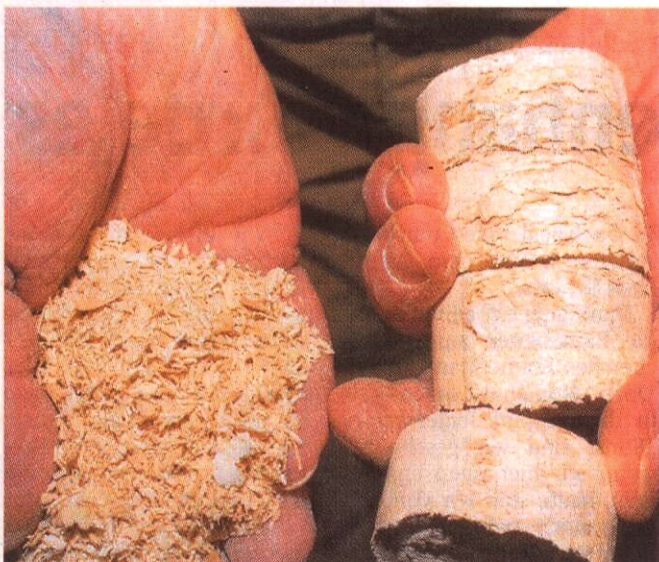
Späne und Sägemehl presst eine Maschine zu Pellet artigen Holzstücken, mit denen Wintertags die Werkstatt geheizt wird.
